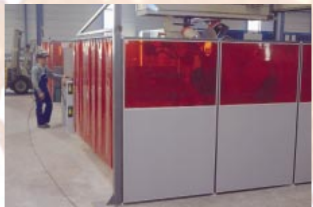
Abb.: 17 Kabine mit LAN SPLACK Element und Schwenkarm im Eingangsbereich
