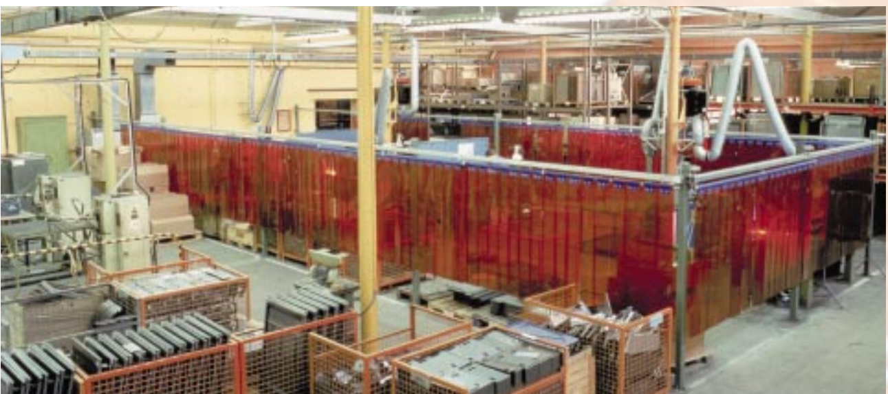
Abb.: 8 Schweißerschutzkabine mit LANSARC – Lamellen 300 x 2 mm, schwere Ausführung, Eingänge seitenschiebbar
