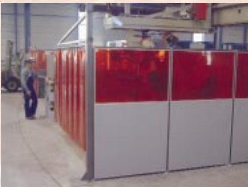
Abb.: 5 Kabine mit LANSPLACK -Schutzscheiben und Schwenkarm als Eingang
