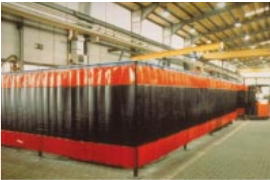
Abb.: 4 LANSMIX -Vorhangkabine, leichtes Montagesystem, C-Profil
