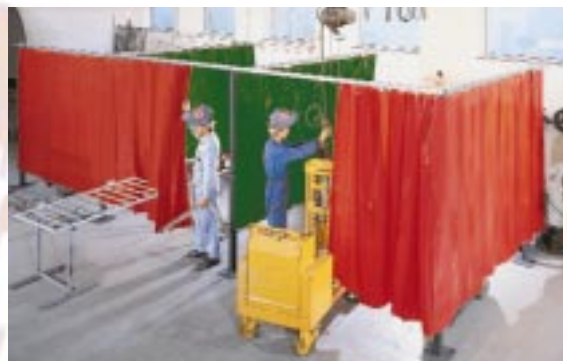
Abb.: 7 Arbeitskabinen mit durchsichtiger Front und dunklen Trennvorhängen
