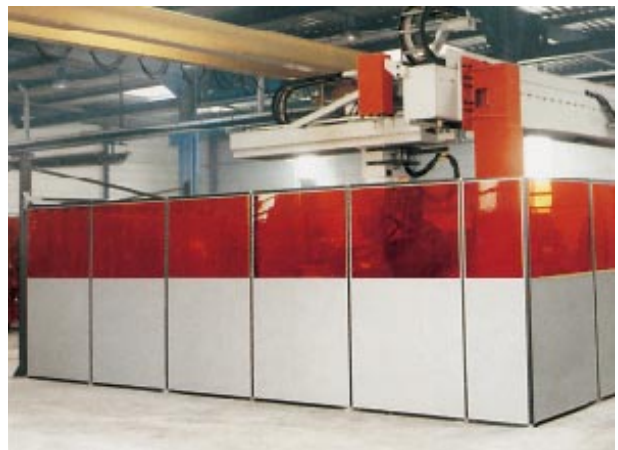
Abb.: 16 LAN SPLACK Schutzkabine für einen Schweißroboter Arbeitsplatz
